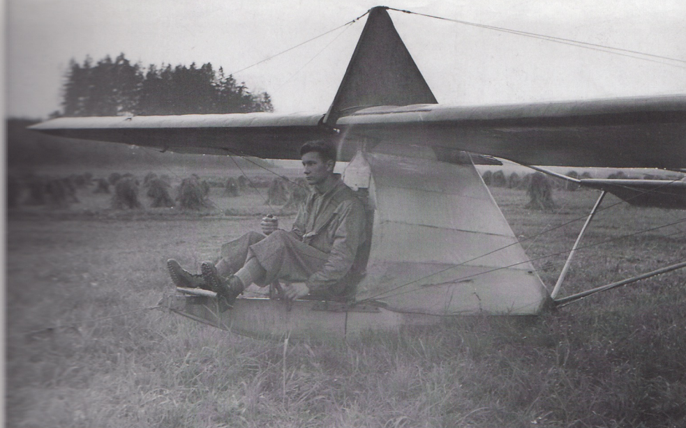
Hans, etwa 20-jährig, auf seinem Schulgleiter SG 38 «Zögling», mit Gummiseil-Start. Die Startmannschaft bringt das Seil auf die optimale Spannung, und beim Kommando «Los!» wird die Startfalle entriegelt. Das Flugzeug wird vom Gummiseil beschleunigt und hebt ab.
